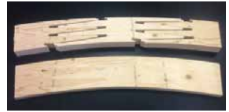
Boven de losse elementen, onder zijn ze verlijmd.
